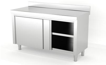
Construidos en Acero Inoxidable AISI 304 18/10 satinado, excepto omegas. Frontal soldado de 60mm en punto redondo. Estante base con doble omega de refuerzo, cajones con guías telescópicas, puertas a 1 cara con bisagra vertical pivotante. Pata cilíndrica de acero inoxidable 150mm regulable 50mm. Se suministran totalmente montados y soldados en embalaje paletizado.
