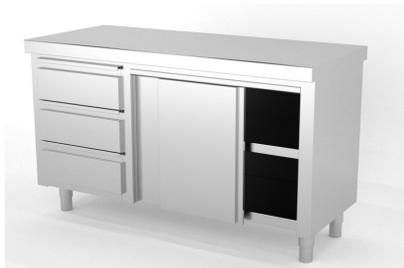
Construidos en Acero Inoxidable AISI 304 18/10 satinado, excepto omegas. Frontal soldado de 60mm en punto redondo. Estante base con doble omega de refuerzo, estante regulable intermedio. Cajones con guías telescópicas, puertas correderas a 1 cara con rodamiento superior de nylon. 6 patas a partir de 2000mm. Pata cilíndrica de acero inoxidable 150mm regulable 50mm. Se suministran totalmente montados y ...
