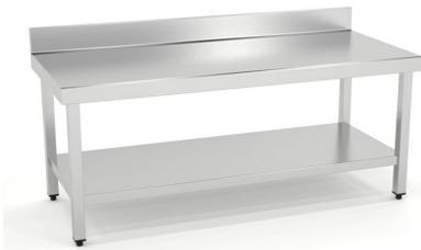
Dimensiones(mm): 600x600x850. Construidas en Acero Inoxidable AISI 304 18/10 satinado y reforzadas con omega. Frontal soldado de 60mm en punto redondo. Peto posterior soldado de 100mm con radio sanitario. Pata de tubo 40x40mm con taco regulable de 60mm. Estante reforzado con omega central. 6 patas a partir de 2000mm.
