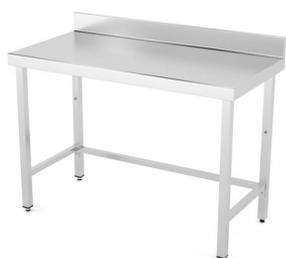
Dimensiones(mm): 600x600x850. Construidas en Acero Inoxidable AISI 304 18/10 satinado reforzado con omega. Frontal soldado de 60mm en punto redondo. Peto posterior soldado de 100mm con radio sanitario. Pata de tubo 40x40 con taco regulable de 60mm. Estante reforzado con omega central. 6 patas a partir de 2000mm.
