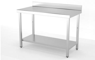
Dimensiones(mm): 600x700x850. Construidas en Acero Inoxidable AISI 304 18/10 satinado reforzado con omega. Frontal soldado de 60mm en punto redondo. Peto posterior soldado de 100mm con radio sanitario. Pata de tubo 40x40 con taco regulable de 60mm. Estante reforzado con omega central. 6 patas a partir de 2000mm.
