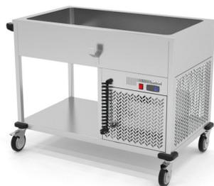
Tensión: 203v/50hz. Potencia: 1/5cv. Construido en acero inoxidable AISI 304 18/10 satinado, cuba cantos sanitarios para cubetas de 150mm de profundidad. refrigeradas mediante serpentín oculto, aislamiento en poliestireno expandido densidad 30kg/m3, unidad condensadora ubicada parte inferior, termostato digital, 4 ruedas giratorias reforzadas de 125ø (2 con freno).
