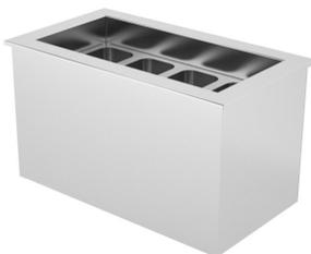
Construidas en Acero Inoxidable AISI 304 18/10. Refrigeradas mediante serpentín oculto. Aisladas con poliestileno expandido. Desagüe inferior en cuba. Elementos para encastrar en encimera. Las unidades condensadoras recomendadas no están incluidas en el precio. Se suministran en embalaje paletizado.
