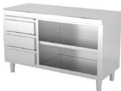
construidos en Acero Inoxidable AISI 304 18/10 satinado, excepto omegas. Frontal soldado de 60mm en punto redondo. Peto posterior soldado de 100mm con radio sanitario. Estante base con doble omega de refuerzo, estante regulable intermedio. Cajones con guías telescópicas. 6 patas a partir de 2000mm. Pata cilíndrica de acero inoxidable 150mm regulable 50mm. Se suministran totalmente montados y soldado...
