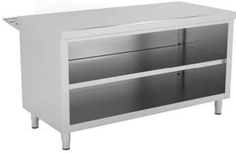
Construidos en Acero Inoxidable AISI 304 18/10 satinado, excepto omegas. Frontal soldado de 60 mm en punto redondo. Estante base con doble omega de refuerzo, estante regulable intermedio reforzado con omega central. 6 patas y refuerzo central a partir de 2000mm. decoración frontal en acero inox con posibilidad de panelado decorativo, pata cilíndrica de acero inoxidable 150mm regulable 50mm. Se suministran en embalaje paletizado.
