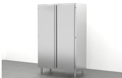
Construidos en Acero Inoxidable AISI 304 18/10. Estante base con doble omega de refuerzo, 3 estantes intermedios regulables y reforzados con omegas inoxidables. Puertas con bisagra vertical desmontable. 6 patas y refuerzo central a partir de 1400mm. Pata cilíndrica de acero inoxidable 150mm regulable 50mm. Se suministran totalmente montados y soldados en embalaje paletizado.
