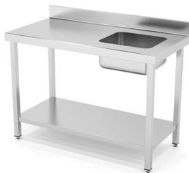
Dimensiones(mm): 1000x700x850. Construidas en Acero Inoxidable AISI 304 18/10 satinado reforzado con omega. Frontal soldado de 60mm en punto redondo. Peto posterior soldado de 100mm con radio sanitario. Cuba soldada 400x340x200mm en mesas fondo 500mm. Cuba soldada 400x400x200mm en mesas fondo 600mm y 700mm. Pata de tubo 40x40 con taco regulable de 60mm. Estante reforzado con omega central.
