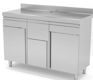
Construidos en Acero Inoxidable AISI 304 18/10 satinado, excepto omegas. Frontal soldado de 60mm en punto redondo. Peto posterior de 100mm con radio sanitario. Estante base con doble omega de refuerzo. Pata cilíndrica de acero inoxidable 150mm regulable 50mm. trasera abierta para facilitar conexiones, tolva café reforzada, cajones con guías telescópicas, puertas batientes con bisagra pivotante. Se ...
