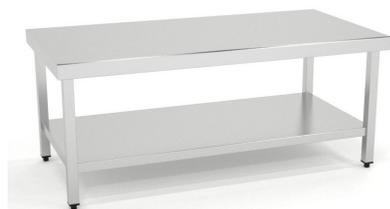
Construidas en Acero Inoxidable AISI 304 18/10 satinado. Frontal de 40mm en mesas de 600. Pata de tubo 30x30 con taco regulable hasta 30mm. Se suministran totalmente soldadas
