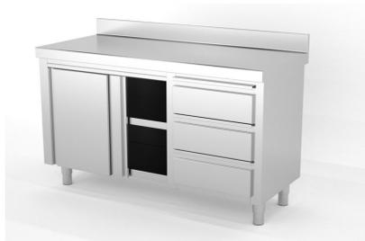
Construidos en Acero Inoxidable AISI 304 18/10 satinado, excepto omegas. Frontal soldado de 60mm en punto redondo. Peto posterior soldado de 100mm con radio sanitario. Estante base con doble omega de refuerzo, estante regulable intermedio. Cajones con guías telescópicas, puertas correderas a 1 cara con rodamiento superior de nylon. 6 patas a partir de 2000mm. Pata cilíndrica de acero inoxidable 15...
