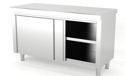
Construidos en Acero Inoxidable AISI 304 18/10 satinado, excepto omegas. Frontal soldado de 60mm en punto redondo. Estante base con doble omega de refuerzo, estante regulable intermedio reforzado con omega central. Puertas correderas a 1 cara con rodamiento superior de nylon. 6 patas y refuerzo central a partir de 2000mm. Pata cilíndrica de acero inoxidable 150mm regulable 50mm. Se suministran totalm...
