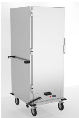
Capacidad: 30 cubetas GN 2/1 Consumo/tensión: 2060w/230v/50-60hz. Construido en acero inoxidable AISI 304 18/10 satinado, cuba cantos sanitarios para cubetas de 150mm de profundidad. Refrigeradas mediante serpentín oculto, aislamiento en poliestireno expandido densidad 30kg/m3,unidad condensadora ubicada parte inferior, termostato digital, 4 ruedas giratorias reforzadas de 125ø (2 con freno).
