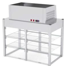
Construidas en Acero Inoxidable AISI 304 18/10 satinado. Iluminación interior LED, Laterales y puertas correderas posteriores de cristal, puertas frontales abatibles de metacrilato transparente. 3 niveles de estante de rejillas inox, Refrigeradas mediante evaporador tiro forzado ubicado en techo. unidad condensadora ubicada en parte superior, Desagüe por gravedad, Temperatura de trabajo 6°C / 10°C...
