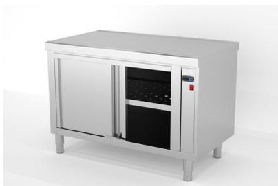
Tensión: 230v/50/60Hz. Construidos en Acero Inoxidable AISI 304 18/10 satinado y reforzados, excepto omegas. Frontal soldado de 60mm en punto redondo. Aislados con lana de roca. Bloque calórico lateral con resistencias ventiladas. Interruptor ON/OFF luminosos y termostato digital 0°-90°. Pata cilíndrica de acero inoxidable 150mm regulable 50mm. Puertas correderas a 1 cara aisladas, rodamientos superior...
