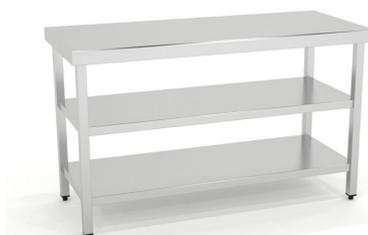
Dimensiones(mm): 600x700x850. Construidas en Acero Inoxidable AISI 304 18/10 satinado y reforzadas con omega. Frontal soldado de 60mm en punto redondo. Patas de tubo 40x40 con taco regulable de 60mm. Estante reforzado con omega central. 6 patas a partir de 2000mm.
