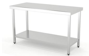
Dimensiones(mm): 600x600x850. Construidas en Acero Inoxidable AISI 304 18/10 satinado reforzado con omega. Frontal soldado de 60mm en punto redondo. Pata de tubo 40x40 con taco regulable de 60mm. Estante reforzado con omega central. 6 patas a partir de 2000mm.
