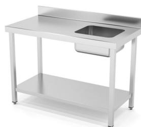
Dimensiones(mm): 1600x500x850. Construidas en Acero Inoxidable AISI 304 18/10 satinado reforzado con omega. Frontal soldado de 60mm en punto redondo. Peto posterior soldado de 100mm con radio sanitario. Cuba soldada 400x340x200mm en mesas fondo 500mm. Cuba soldada 400x400x200mm en mesas fondo 600mm y 700mm. Pata de tubo 40x40 con taco regulable de 60mm. Estante reforzado con omega central.
