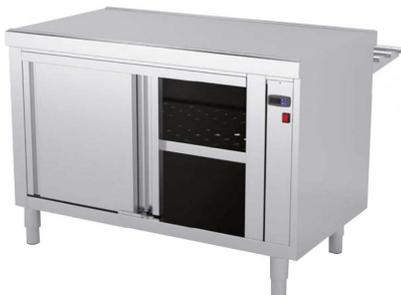
Construidos en Acero Inoxidable AISI 304 18/10 satinado. frontal soldado de 60mm, aislados con lana de roca, bloque calórico lateral con resistencias ventiladas. Interruptor ON/OFF luminoso y termostato digital 0°-90°. cerrado con puertas correderas en zona reserva, decoración frontal en acero inox con posibilidad de panelado decorativo, pata cilíndrica de acero inoxidable 150mm regulable 50mm.Se ...
