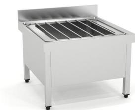
Construidos en Acero Inoxidable AISI 304 18/10 satinado. Frontal soldado de 60mm en punto redondo. Peto posterior soldado de 100mm con radio sanitario. Válvula desagüe y tubo rebosaderos incluidos. Rejilla superior móvil para soporte recipientes. Se suministran totalmente montados y soldados a bastidor en embalaje paletizado
