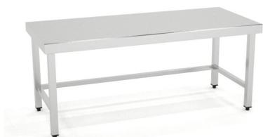
Construidas en Acero Inoxidable AISI 304 18/10 satinado. Frontal de 30mm en mesas de 500mm. Pata de tubo 30x30 con taco regulable hasta 30mm. Se suministran totalmente soldadas
