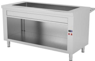
Construidos en Acero Inoxidable AISI 304 18/10 satinado. frontal soldado de 60mm, Cuba con radios sanitarios para cubetas de 150mm de profundidad. Aisladas con lana de roca. Resistencias vistas con chapa perforada de protección. Interruptor ON/OFF luminoso y termostato digital 0°-90°. decoración frontal en acero inox con posibilidad de panelado decorativo, pata cilíndrica de acero inoxidable 150mm...
