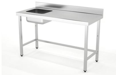
Dimensiones(mm): 1000x600x850. Construidas en Acero Inoxidable AISI 304 18/10 satinado reforzado con omega. Frontal soldado de 60mm en punto redondo. Peto posterior de 100mm con radio sanitario. Cuba soldada 400x340x200mm en mesas fondo 500mm. Cuba soldada 400x400x200mm en mesas fondo 600mm y 700mm. Pata de tubo 40x40 con taca regulable de 60mm. Estante reforzado con omega central.
