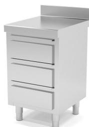
Construidos en Acero Inoxidable AISI 304 18/10 satinado, excepto omegas. Frontal soldado de 60mm en punto redondo. Peto posterior soldado de 100mm con radio sanitario. Estante base con doble omega de refuerzo, cajones con guías telescópicas. Pata cilíndrica de acero inoxidable 150mm regulable 50mm. Se suministran totalmente montados y soldados en embalaje paletizado.
