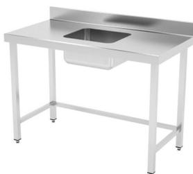
Dimensiones(mm): 1600x600x850. Construidas en Acero Inoxidable AISI 304 18/10 satinado reforzado con omega. Frontal soldado de 60mm en punto redondo. Peto posterior soldado de 100mm con radio sanitario. Cuba soldada 400x340x200mm en mesas fondo 500mm. Cuba soldada 400x400x200mm en mesas fondo 600mm y 700mm. Pata de tubo 40x40 con taco regulable de 60mm. Estante reforzado con omega central.
