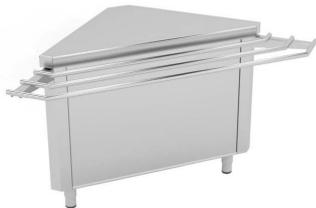
Construidos en Acero Inoxidable AISI 304 18/10 satinado, excepto omegas. Frontal soldado de 60 mm en punto redondo. Estante base con doble omega de refuerzo, estante regulable intermedio reforzado con omega central. decoración frontal en acero inox con posibilidad de panelado decorativo, pata cilíndrica de acero inoxidable 150mm regulable 50mm. Se suministran en embalaje paletizado.
