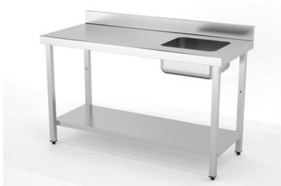
Dimensiones(mm): 1200x500x850. Construidas en Acero Inoxidable AISI 304 18/10 satinado reforzado con omega. Frontal soldado de 60mm en punto redondo. Peto posterior de 100mm con radio sanitario. Cuba soldada 400x340x200mm en mesas fondo 500mm. Cuba soldada 400x400x200mm en mesas fondo 600mm y 700mm. Pata de tubo 40x40 con taco regulable de 60mm. Estante reforzado con omega central.
