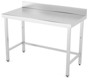
Dimensiones(mm): 600x700x850. Construidas en Acero Inoxidable AISI 304 18/10 satinado reforzado con omega. Frontal soldado de 60mm en punto redondo. Peto posterior soldado de 100mm con radio sanitario. Pata de tubo 40x40 con taco regulable de 60mm. Estante reforzado con omega central. 6 patas a partir de 2000mm.
