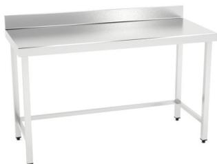
Construidas en Acero Inoxidable AISI 304 18/10 satinado. Frontal de 40mm en mesas de 700mm. Peto trasero girada recta de 40mm en mesas de 700mm. Pata de tubo 30x30 con taco regulable hasta 30mm. Se suministran totalmente soldadas
