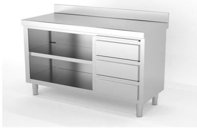
Construidos en Acero Inoxidable AISI 304 18/10 satinado, excepto omegas. Frontal soldado de 60mm en punto redondo. Peto posterior soldado de 100mm con radio sanitario. Estante base con doble omega de refuerzo, estante regulable intermedio. Cajones con guías telescópicas. 6 patas a partir de 2000mm. Pata cilíndrica de acero inoxidable 150mm regulable 50mm. Se suministran totalmente montados y soldado...
