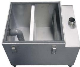
Dimensiones: 500x400x400mm Construido en acero inoxidable AISI 304 18/10 satinado, entrada de agua residual en 1 lateral, sistema interno de separación de grasas y sólidos por diferencias de densidad en los materiales, salida de agua libre de grasas por lateral opuesto.
