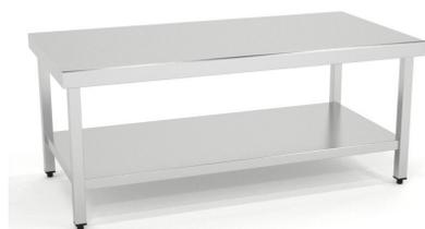
Mesas de fondo 800 y altura 600. Construidas en Acero Inoxidable AISI 304 18/10 satinado y reforzadas con omega. Frontal soldado de 60mm en punto redondo. Pata de tubo 40x40 con taco regulable de 60mm. Estante reforzado con omega central. 6 patas a partir de 2000mm.
