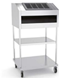
Construidos en Acero Inoxidable AISI 304 18/10 satinado, excepto omegas. tolva de pan con puerta posterior y cubertero superior, 1 estante base + 1 intermedio para bandejas, cubiertos o vasos, 4 ruedas giratorias de 125° (2 con freno). Se suministran en embalaje paletizado.
