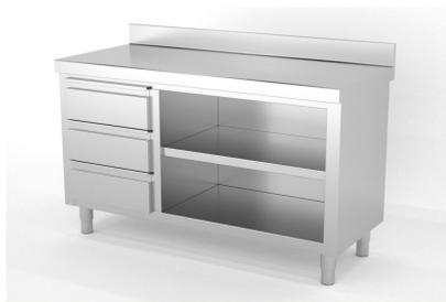
Construidos en Acero Inoxidable AISI 304 18/10 satinado, excepto omegas. Frontal soldado de 60mm en punto redondo. Peto posterior soldado de 100mm con radio sanitario. Estante base con doble omega de refuerzo, estante regulable intermedio. Cajones con guías telescópicas. 6 patas a partir de 2000mm. Pata cilíndrica de acero inoxidable 150mm regulable 50mm. Se suministran totalmente montados y soldado...
