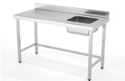
Dimensiones(mm): 1200x500x850. Construidas en Acero Inoxidable AISI 304 18/10 satinado reforzado con omega. Frontal soldado de 60mm en punto redondo. Peto posterior de 100mm con radio sanitario. Cuba soldada 400x340x200mm en mesas fondo 500mm. Cuba soldada 400x400x200mm en mesas fondo 600mm y 700mm. Pata de tubo 40x40 con taco regulable de 60mm. Estante reforzado con omega central.
