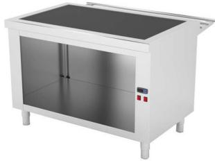
Construidas en Acero Inoxidable AISI 304 18/10 satinado. Frontal soldado de 60mm, Placa de cristal templado negro, Aisladas con lana de roca. Resistencias ocultas. Interruptor ON/OFF luminoso y termostato digital 0°-90°. decoración frontal en acero inox con posibilidad de panelado decorativo, pata cilíndrica de acero inoxidable 150mm regulable 50mm. Se suministran en embalaje paletizado.
