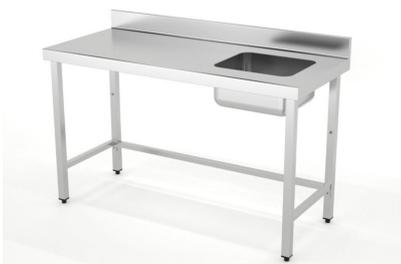
Dimensiones(mm): 1000x600x850. Construidas en Acero Inoxidable AISI 304 18/10 satinado reforzado con omega. Frontal soldado de 60mm en punto redondo. Peto posterior de 100mm con radio sanitario. Cuba soldada 400x340x200mm en mesas fondo 500mm. Cuba soldada 400x400x200mm en mesas fondo 600mm y 700mm. Pata de tubo 40x40 con taco regulable de 60mm. Estante reforzado con omega central.
