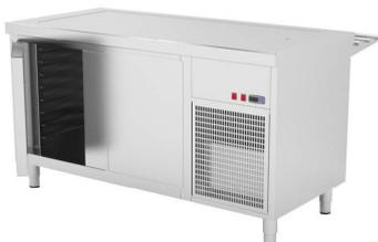
Construidos en Acero Inoxidable AISI 304 18/10 satinado. frontal soldado de 60mm, Cuba con radios sanitarios para cubetas de 150mm de profundidad. Refrigeradas mediante serpentín oculto. Aisladas con poliestileno expandido. Desagüe inferior en cuba, termostato digital, reserva inferior refrigerada, puertas batientes aisladas con guías para cubetas GN1/1 en zona de reserva, decoración frontal en ace...
