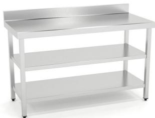
Dimensiones(mm): 600x600x850. Construidas en Acero Inoxidable AISI 304 18/10 satinado y reforzadas con omega. Frontal soldado de 60mm en punto redondo. Patas de tubo 40x40 con taco regulable de 60mm. Estante reforzado con omega central. 6 patas a partir de 2000mm.
