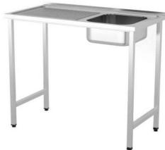
Alto: 850 mm Construidos en Acero Inoxidable AISI 304 18/10 satinado. Frontal 40mm en punto recto. Peto posterior 40mm girada recta. Válvula con tapón incluidos. Pata de tubo 30x30mm con taco regulable hasta 30mm. Con posibilidad de espacio para lavavajillas de hasta 600x600x820mm. Se suministran totalmente montados y soldados. Gama de fregaderos soldados de alta calidad fabricados en España diseñados ...
