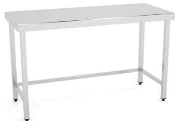
Dimensiones(mm): 600x600x850. Construidas en Acero Inoxidable AISI 304 18/10 satinado reforzado con omega. Frontal soldado de 60mm en punto redondo. Pata de tubo 40x40 con taco regulable de 60mm. Estante reforzado con omega central. 6 patas a partir de 2000mm.
