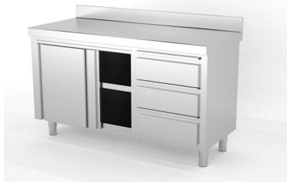
Construidos en Acero Inoxidable AISI 304 18/10 satinado, excepto omegas. Frontal soldado de 60mm en punto redondo. Peto posterior soldado de 100mm con radio sanitario. Estante base con doble omega de refuerzo, estante regulable intermedio. Cajones con guías telescópicas, puertas correderas a 1 cara con rodamiento superior de nylon. 6 patas a partir de 2000mm. Pata cilíndrica de acero inoxidable 15...
