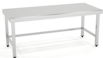
Fondo 800 - Altura 600 Construidas en Acero Inoxidable AISI 304 18/10 satinado y reforzadas con omega. Frontal soldado de 60mm en punto redondo. Patas de tubo 40x40 con taco regulable de 60mm. Estante reforzado con omega central. 6 patas a partir de 2000mm.
