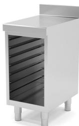
Construidos en Acero Inoxidable AISI 304 18/10 satinado, excepto omegas. Frontal soldado de 60mm en punto redondo. Peto posterior soldado de 100mm con radio sanitario, cuerpo de guías de 1.5mm de espesor. Estante base con doble omega de refuerzo, pata cilíndrica de acero inoxidable regulable hasta 50mm. Se suministran totalmente montados y soldados en embalaje paletizado.
