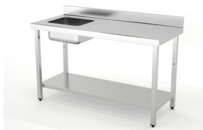
Dimensiones(mm): 1000x700x850. Construidas en Acero Inoxidable AISI 304 18/10 satinado reforzado con omega. Frontal soldado de 60mm en punto redondo. Peto posterior de 100mm con radio sanitario. Cuba soldada 400x340x200mm en mesas fondo 500mm. Cuba soldada 400x400x200mm en mesas fondo 600mm y 700mm. Pata de tubo 40x40 con taco regulable de 60mm. Estante reforzado con omega central.
