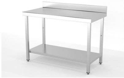
Dimensiones(mm): 600x600x850. Construidas en Acero Inoxidable AISI 304 18/10 satinado reforzado con omega. Frontal soldado de 60mm en punto redondo. Peto posterior soldado de 100mm con radio sanitario. Pata de tubo 40x40 con taco regulable de 60mm. Estante reforzado con omega central. 6 patas a partir de 2000mm.
