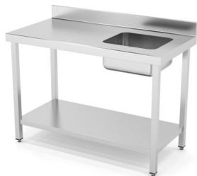
Dimensiones(mm): 1000x600x850. Construidas en Acero Inoxidable AISI 304 18/10 satinado reforzado con omega. Frontal soldado de 60mm en punto redondo. Peto posterior soldado de 100mm con radio sanitario. Cuba soldada 400x340x200mm en mesas fondo 500mm. Cuba soldada 400x400x200mm en mesas fondo 600mm y 700mm. Pata de tubo 40x40 con taco regulable de 60mm. Estante reforzado con omega central.
