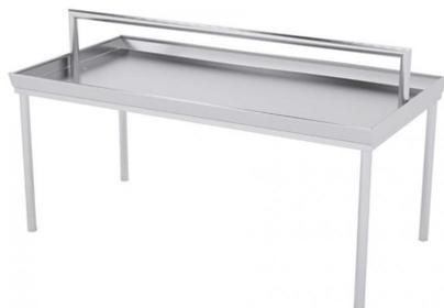
Construidas en Acero Inoxidable AISI 304 18/10 satinado. soportes laterales de sujeción, marco perimetral en chapa 2mm, Pata de tubo 40x40mm con taco regulable hasta 60mm .
