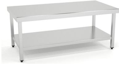
Mesas de fondo 700 y altura 600. Construidas en Acero Inoxidable AISI 304 18/10 satinado y reforzadas con omega. Frontal soldado de 60mm en punto redondo. Pata de tubo 40x40 con taco regulable de 60mm. Estante reforzado con omega central. 6 patas a partir de 2000mm.
