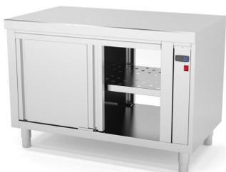
Tensión: 230v/50/60Hz. Construidos en Acero Inoxidable AISI 304 18/10 satinado y reforzados, excepto omegas. Frontal soldado de 60mm en punto redondo. Aislados con lana de roca. Bloque calórico lateral con resistencias ventiladas. Interruptor ON/OFF luminosos y termostato digital 0°-90°. Pata cilíndrica de acero inoxidable 150mm regulable 50mm. Puertas correderas a 1 cara aisladas, rodamientos superior...
