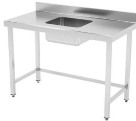
Dimensiones(mm): 1600x700x850. Construidas en Acero Inoxidable AISI 304 18/10 satinado reforzado con omega. Frontal soldado de 60mm en punto redondo. Peto posterior soldado de 100mm con radio sanitario. Cuba soldada 400x340x200mm en mesas fondo 500mm. Cuba soldada 400x400x200mm en mesas fondo 600mm y 700mm. Pata de tubo 40x40 con taco regulable de 60mm. Estante reforzado con omega central.
