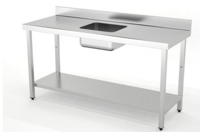
Dimensiones(mm): 1600x600x850. Construidas en Acero Inoxidable AISI 304 18/10 satinado reforzado con omega. Frontal soldado de 60mm en punto redondo. Peto posterior de 100mm con radio sanitario. Cuba soldada 400x340x200mm en mesas fondo 500mm. Cuba soldada 400x400x200mm en mesas fondo 600mm y 700mm. Pata de tubo 40x40 con taco regulable de 60mm. Estante reforzado con omega central.
