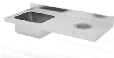
Construidos en Acero Inoxidable AISI 304 18/10 satinado. Frontal soldado de 60mm en punto redondo. Peto posterior soldado de 100mm con radio sanitario. Válvula desagüe y tubo rebosaderos incluidos. Aro desbarace troncónico en caucho gris.
