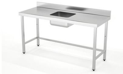
Dimensiones(mm): 1600x600x850. Construidas en Acero Inoxidable AISI 304 18/10 satinado reforzado con omega. Frontal soldado de 60mm en punto redondo. Peto posterior de 100mm con radio sanitario. Cuba soldada 400x340x200mm en mesas fondo 500mm. Cuba soldada 400x400x200mm en mesas fondo 600mm y 700mm. Pata de tubo 40x40 con taca regulable de 60mm. Estante reforzado con omega central.
