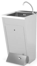
Construidos en Acero Inoxidable AISI 304 18/10 satinado. Peto posterior 30mm girada recta. Cubeta de 365x340x150mm. Válvula desagüe con tapón incluidos. Puerta frontal registrable. Caño alto y pulsador temporizado en los modelos 1 agua y 2 aguas, latiguillos de 1/2 incluidos.
