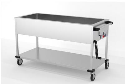
Tensión: 230v/50-60hz. Construidos en Acero Inoxidable AISI 304 18/10. Cuba con radios sanitarios para cubetas de 150mm de profundidad. Aislados con lana de roca. Resistencias ocultas. Interruptor ON/OFF luminoso y termostato digital 0°-90°. Desagüe con grifo de bola inferior. Estructura en tubo 40x40mm con estante inferior soldado. 4 ruedas giratorias de 125ø (2 con freno).
