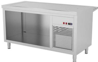
Construidos en Acero Inoxidable AISI 304 18/10 satinado. Frontal soldado de 60mm, placa con roldana salvaguas perimetral. Refrigerada mediante serpentín oculto. Aisladas con poliestileno expandido. Desagüe inferior en placa. termostato digital, decoración frontal en acero inox con posibilidad de panelado decorativo, pata cilíndrica de acero inoxidable 150mm regulable 50mm. Se suministran en embalaj...
