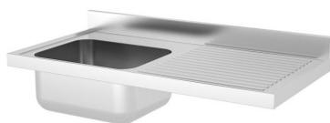
Construidos en Acero Inoxidable AISI 304 18/10 satinado. Frontal soldado de 30mm en punto recto. Cuba de 340x365x150mm. Peto posterior 30mm girada recta. Válvula con tapón incluidos. Gama de fregaderos de alta calidad fabricados en España diseñados para la instalación con soporte a pared (cartela).
