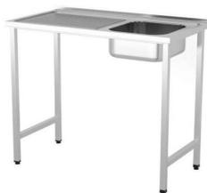
Alto: 850 mm Construidos en Acero Inoxidable AISI 304 18/10 satinado. Frontal 40mm en punto recto. Peto posterior 40mm girada recta. Válvula con tapón incluidos. Pata de tubo 30x30mm con taco regulable hasta 30mm. Con posibilidad de espacio para lavavajillas de hasta 600x600x820mm. Se suministran totalmente montados y soldados. Gama de fregaderos soldados de alta calidad fabricados en España diseñados c...
