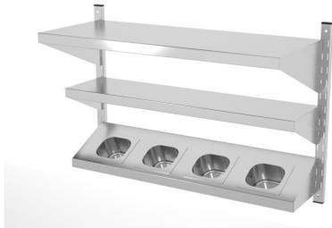
Construidas en Acero Inoxidable AISI 304 18/10 satinado. Regulación de estantes mediante cremallera en tubo. Se suministran totalmente soldadas y embaladas. Dotación de tacos y tornillos para su instalación. Ejemplo de composición. Cubetas no incluidas
