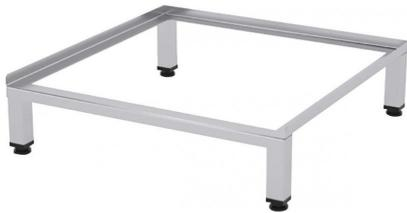
Construidas en Acero Inoxidable AISI 304 18/10 satinado. Soportes laterales de sujeción, marco perimetral en chapa 2mm, Pata de tubo 40x40mm con taco regulable hasta 60mm .
