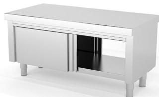
Construidos en Acero Inoxidable AISI 304 18/10 satinado, excepto omegas. Frontal soldado de 60mm en punto redondo. Estante base con doble omega de refuerzo, estante regulable intermedio reforzado con omega central. Puertas correderas a 2 caras con rodamiento superior de nylon. 6 patas y refuerzo central a partir de 2000mm. Pata cilíndrica de acero inoxidable 150mm regulable 50mm. Se suministran tota...
