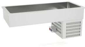
Construidas en Acero Inoxidable AISI 304 18/10 satinado. Cuba con radios sanitarios para cubetas de 150mm de profundidad. Refrigeradas mediante serpentín oculto. Aisladas con poliestileno expandido. Desagüe inferior en cuba. Unidad condensadora incorporada en parte inferior, con cuadro de mandos móvil (máx. 1m). Temperatura de trabajo 1°C / 5°C. Elementos para encastrar en encimera. Se suministran e...
