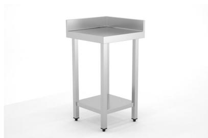
Dimensiones (mm): 500x500x850. Construidas en Acero Inoxidable AISI 304 18/10 satinado reforzadas con omegas. Frontal soldado de 60mm en punto redondo. Peto posterior y lateral de 100mm con radio sanitario. Se suministran totalmente montadas y soldadas en embalaje paletizado.
