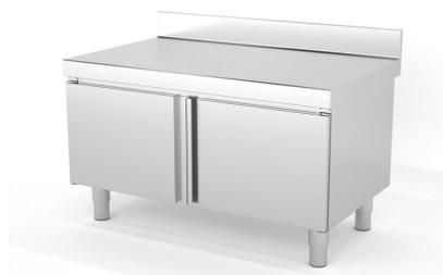
Construidos en Acero Inoxidable AISI 304 18/10 satinado, excepto omegas. Frontal soldado de 60mm en punto redondo. Peto posterior soldado de 100mm con radio sanitario. Estante base con doble omega de refuerzo, estante intermedio reforzado con omega central. Puertas a 1 cara con bisagra vertical pivotante. 6 patas y refuerzo central a partir de 2000mm. Pata cilíndrica de acero inoxidable 150mm regul...
