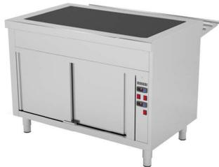
Construidas en Acero Inoxidable AISI 304 18/10 satinado. Frontal soldado de 60mm, Placa de cristal vitrocerámico negro, Aisladas con lana de roca. Resistencias ocultas. Interruptor ON/OFF luminoso y termostato digital 0°-90°. cerrado con puertas correderas en zona reserva, decoración frontal en acero inox con posibilidad de panelado decorativo, pata cilíndrica de acero inoxidable 150mm regulable 5...
