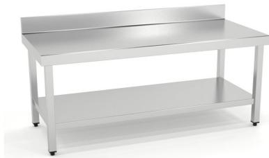
Fondo 700 - Altura 600 Construidas en Acero Inoxidable AISI 304 18/10 satinado y reforzadas con omega. Frontal soldado de 60mm en punto redondo. Patas de tubo 40x40 con taco regulable de 60mm. Estante reforzado con omega central. 6 patas a partir de 2000mm.
