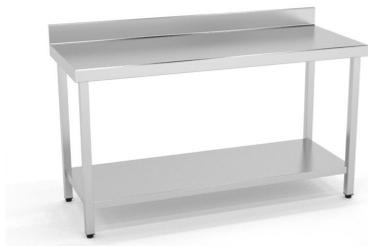
Dimensiones(mm): 600x600x850. Construidas en Acero Inoxidable AISI 304 18/10 satinado y reforzadas con omega. Frontal soldado de 60mm en punto redondo. Patas de tubo 40x40 con taco regulable de 60mm. Estante reforzado con omega central. 6 patas a partir de 2000mm.
