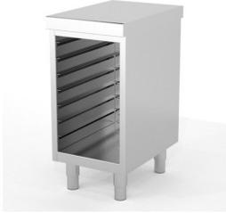
Construidos en Acero Inoxidable AISI 304 18/10 satinado, excepto omegas. Frontal soldado de 60mm en punto redondo. Cuerpo de guías de 1.5mm de espesor. Estante base con doble omega de refuerzo. Pata cilíndrica de acero inoxidable 150mm regulable 50mm. Se suministran totalmente montados y soldados en embalaje paletizado.
