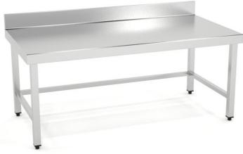
Dimensiones(mm): 600x600x850. Construidas en Acero Inoxidable AISI 304 18/10 satinado y reforzadas con omega. Frontal soldado de 60mm en punto redondo. Peto posterior soldado de 100mm con radio sanitario. Pata de tubo 40x40mm con taco regulable de 60mm. Estante reforzado con omega central. 6 patas a partir de 2000mm.
