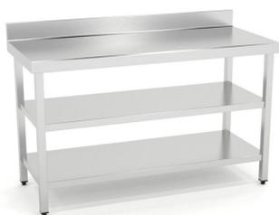
Dimensiones(mm): 600x500x850. Construidas en Acero Inoxidable AISI 304 18/10 satinado y reforzadas con omega. Frontal soldado de 60mm en punto redondo. Patas de tubo 40x40 con taco regulable de 60mm. Estante reforzado con omega central. 6 patas a partir de 2000mm.
