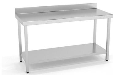
Construidas en Acero Inoxidable AISI 304 18/10 satinado. Frontal de 40mm en mesas de 700mm. Peto trasero girada recta de 40mm en mesas de 700mm. Pata de tubo 30x30 con taco regulable hasta 30mm. Se suministran totalmente soldadas
