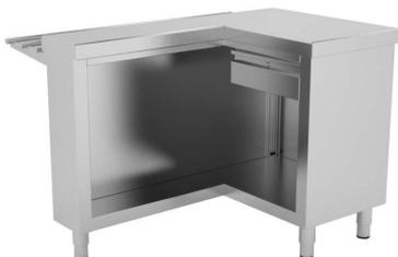
Construidos en Acero Inoxidable AISI 304 18/10 satinado, excepto omegas. Frontal soldado de 60 mm en punto redondo. Estante base con doble omega de refuerzo, cajón guías telescópicas con cerradura, decoración frontal en acero inox con posibilidad de panelado decorativo, pata cilíndrica de acero inoxidable 150mm regulable 50mm. Se suministran en embalaje paletizado.
