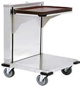
Construidos en Acero Inoxidable AISI 304 18/10 satinado. para bandejas de autoservicio, regulación de nivel mediante muelles, carga máxima 80kg. 4 ruedas giratorias de 100° (2 con freno). Se suministran en embalaje paletizado.
