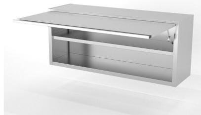
Construidos en Acero Inoxidable AISI 304 18/10. Estante base con doble omega de refuerzo, 1 estante intermedio regulable y reforzado con omega inoxidable. Puerta abatible con bisagra de piano superior y bisagras de compás. Se suministran totalmente montados y soldados en embalaje paletizado.
