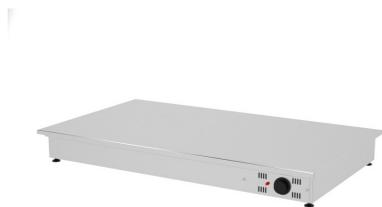
Construidas en Acero Inoxidable AISI 304 18/10 satinado. Aisladas con lana de roca. Resistencias ocultas. Interruptor ON/OFF luminoso y termostato analógico 0°-90°. Elementos de sobremesa o para encastrar en encimera. Se suministran en embalaje paletizado.
