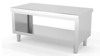
Construidos en Acero Inoxidable AISI 304 18/10 satinado, excepto omegas. Frontal soldado de 60mm en punto redondo. Estante base con doble omega de refuerzo, estante regulable intermedio reforzado con omega central. 6 patas y refuerzo central a partir de 2000mm. Pata cilíndrica de acero inoxidable 150mm regulable 50mm. Se suministran totalmente montados y soldados en embalaje paletizado.
