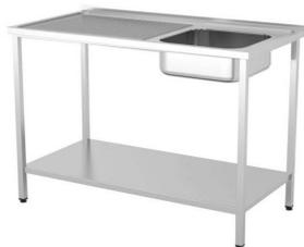
Alto: 850 mm Construidos en Acero Inoxidable AISI 304 18/10 satinado. Frontal 40mm en punto recto. Peto posterior 40mm girada recta. Válvula con tapón incluidos. Pata de tubo 30x30mm con taco regulable hasta 30mm. 1 estante inferior soldado a estructura en modelo con estante. Se suministran totalmente montados y soldados. Gama de fregaderos soldados de alta calidad fabricados en España diseñados con ba...
