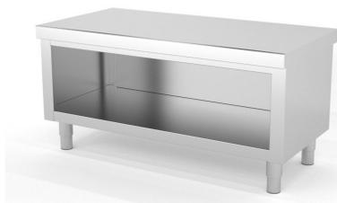
Construidos en Acero Inoxidable AISI 304 18/10 satinado, excepto omegas. Frontal soldado de 60mm en punto redondo. Estante base con doble omega de refuerzo, estante regulable intermedio reforzado con omega central. 6 patas y refuerzo central a partir de 2000mm. Pata cilíndrica de acero inoxidable 150mm regulable 50mm. Se suministran totalmente montados y soldados en embalaje paletizado.
