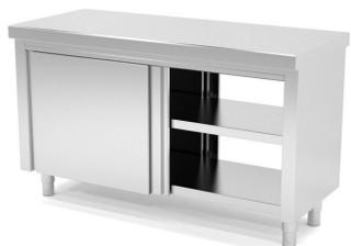
Construidos en Acero Inoxidable AISI 304 18/10 satinado, excepto omegas. Frontal soldado de 60mm en punto redondo. Estante base con doble omega de refuerzo, estante regulable intermedio reforzado con omega central. Puertas correderas a 2 caras con rodamiento superior de nylon. 6 patas y refuerzo central a partir de 2000mm. Pata cilíndrica de acero inoxidable 150mm regulable 50mm. Se suministran tota...
