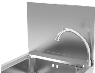
Dimensiones: 450x20x300mm Construidos en Acero Inoxidable AISI 304 18/10 satinado. Peto posterior 30mm girada recta. Cubeta de 365x340x150mm. Válvula desagüe con tapón incluidos. Puerta frontal registrable. Caño alto y pulsador temporizado en los modelos 1 agua y 2 aguas, latiguillos de 1/2 incluidos.
