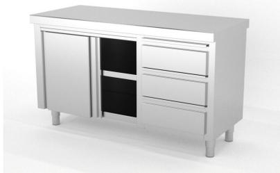
Construidos en Acero Inoxidable AISI 304 18/10 satinado, excepto omegas. Frontal soldado de 60mm en punto redondo. Estante base con doble omega de refuerzo, estante regulable intermedio. Cajones con guías telescópicas, puertas correderas a 1 cara con rodamiento superior de nylon. 6 patas a partir de 2000mm. Pata cilíndrica de acero inoxidable 150mm regulable 50mm. Se suministran totalmente montados y ...
