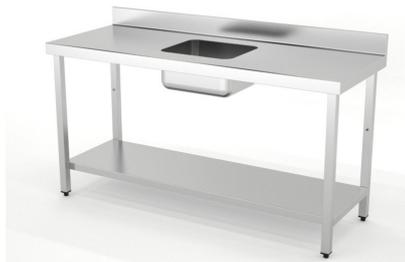
Dimensiones(mm): 1600x600x850. Construidas en Acero Inoxidable AISI 304 18/10 satinado reforzado con omega. Frontal soldado de 60mm en punto redondo. Peto posterior soldado de 100mm con radio sanitario. Cuba soldada 400x340x200mm en mesas fondo 500mm. Cuba soldada 400x400x200mm en mesas fondo 600mm y 700mm. Pata de tubo 40x40 con taco regulable de 60mm. Estante reforzado con omega central.
