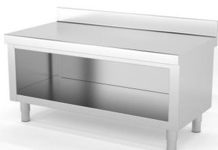
Construidos en Acero Inoxidable AISI 304 18/10 satinado, excepto omegas. Frontal soldado de 60mm en punto redondo. Peto posterior soldado de 100mm con radio sanitario. Estante base con doble omega de refuerzo, estante regulable intermedio reforzado con omega central. 6 patas y refuerzo central a partir de 2000mm. Pata cilíndrica de acero inoxidable 150mm regulable 50mm. Se suministran totalmente mon...
