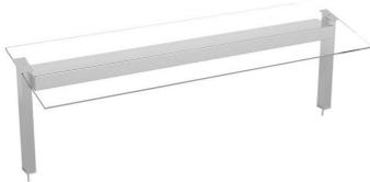
Construidas en Acero Inoxidable AISI 304 18/10. Soportes verticales en tubo rectangular 60x40mm, unidos con tubo horizontal o cuerpo de pantalla (según modelo) cristal superior inclinado con sujeción mediante tornillos. Fijación inferior mediante varilla roscada a encimera. Se suministran en embalaje paletizado.
