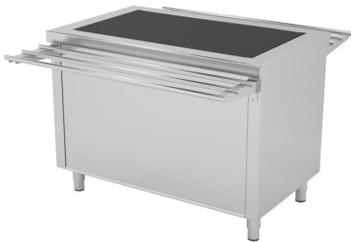
Construidos en Acero Inoxidable AISI 304 18/10 satinado. frontal soldado de 60mm. Cuba con radios sanitarios para cubetas de 150mm de profundidad. Aisladas con lana de roca. Resistencias ocultas. Interruptor ON/OFF luminoso y termostato digital 0°-90°. Llenado y Desagüe con grifo bola. decoración a 2 caras en acero inox con posibilidad de panelado decorativo, pata cilíndrica de acero inoxidable 15...
