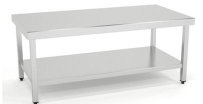
Mesas de fondo 600 y altura 600. Construidas en Acero Inoxidable AISI 304 18/10 satinado y reforzadas con omega. Frontal soldado de 60mm en punto redondo. Pata de tubo 40x40 con taco regulable de 60mm. Estante reforzado con omega central. 6 patas a partir de 2000mm.
