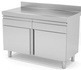
Construidos en Acero Inoxidable AISI 304 18/10 satinado, excepto omegas. Frontal soldado de 60mm en punto redondo. Estante base con doble omega de refuerzo, cajones con guías telescópicas, puertas a 1 cara con bisagra vertical pivotante. Pata cilíndrica de acero inoxidable 150mm regulable 50mm. Se suministran totalmente montados y soldados en embalaje paletizado.
