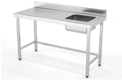
Dimensiones(mm): 1000x700x850. Construidas en Acero Inoxidable AISI 304 18/10 satinado reforzado con omega. Frontal soldado de 60mm en punto redondo. Peto posterior de 100mm con radio sanitario. Cuba soldada 400x340x200mm en mesas fondo 500mm. Cuba soldada 400x400x200mm en mesas fondo 600mm y 700mm. Pata de tubo 40x40 con taca regulable de 60mm. Estante reforzado con omega central.
