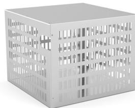
Construida en Acero Inoxidable AISI 304 18/10 satinado, totalmente perforada para una correcta ventilación, laterales y techo desmontables. Preparada para incorporar y proteger unidades condensadoras de cubas y placas frías con motor remoto.
