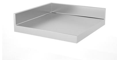
Dimensiones (mm): 500x500x60. Construidas en Acero Inoxidable AISI 304 18/10 satinado reforzadas con omegas. Frontal soldado de 60mm en punto redondo. Peto posterior y lateral de 100mm con radio sanitario. Se suministran totalmente montadas y soldadas en embalaje paletizado.
