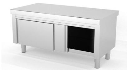
Construidos en Acero Inoxidable AISI 304 18/10 satinado, excepto omegas. Frontal soldado de 60mm en punto redondo. Estante base con doble omega de refuerzo, estante regulable intermedio reforzado con omega central. Puertas correderas a 1 cara con rodamiento superior de nylon. 6 patas y refuerzo central a partir de 2000mm. Pata cilíndrica de acero inoxidable 150mm regulable 50mm. Se suministran totalm...
