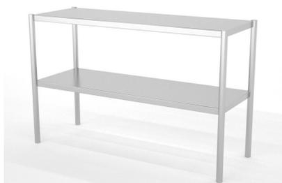
Construidos en Acero Inoxidable AISI 304 18/10 satinado y reforzados con omegas inoxidables. Se suministran totalmente montados, soldados y embalados. 6 patas a partir de 2100mm. Dotación de tornillos para su fijación a encimera.
