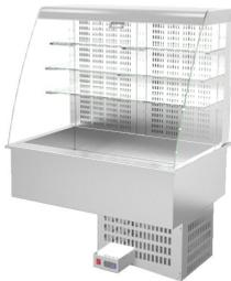
Construidas en Acero Inoxidable AISI 304 18/10 satinado. Laterales de cristal, 3 niveles de estante regulable en cristal, Iluminación LED, cortina nocturna, aisladas con poliestireno expandido. Cuba con radios rectos para cubetas de 150mm de profundidad, piso inferior desmontable, cuba y vitrina refrigeradas mediante evaporador tiro forzado en parte inferior. Unidad condensadora incorporada en par...
