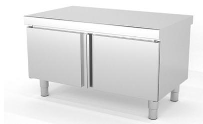
Construidos en Acero Inoxidable AISI 304 18/10 satinado, excepto omegas. Frontal soldado de 60mm en punto redondo. Estante base con doble omega de refuerzo, estante regulable intermedio reforzado con omega central. Puertas a 1 cara con bisagra vertical pivotante. 6 patas y refuerzo central a partir de 2000mm. Pata cilíndrica de acero inoxidable 150mm regulable 50mm. Se suministran totalmente montados...
