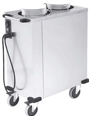
Construidos en Acero Inoxidable AISI 304 18/10 satinado. para platos de 240° a 320°, regulación de nivel mediante muelles, carga máxima 70kg., modelo caliente con aislamiento con lana de roca. Resistencias inferiores, interruptor ON/OFF luminoso y termostato analógico 0°-90°. 4 ruedas giratorias de 100° (2 con freno). Se suministran en embalaje paletizado.
