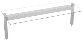
Construidas en Acero Inoxidable AISI 304 18/10. Soportes verticales en tubo rectangular 60x40mm, unidos con tubo horizontal o cuerpo de pantalla (según modelo) cristal superior inclinado con sujeción mediante tornillos. Fijación inferior mediante varilla roscada a encimera. Se suministran en embalaje paletizado. Cristal no incluido en el precio.
