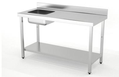
Dimensiones(mm): 1000x600x850. Construidas en Acero Inoxidable AISI 304 18/10 satinado reforzado con omega. Frontal soldado de 60mm en punto redondo. Peto posterior de 100mm con radio sanitario. Cuba soldada 400x340x200mm en mesas fondo 500mm. Cuba soldada 400x400x200mm en mesas fondo 600mm y 700mm. Pata de tubo 40x40 con taco regulable de 60mm. Estante reforzado con omega central.
