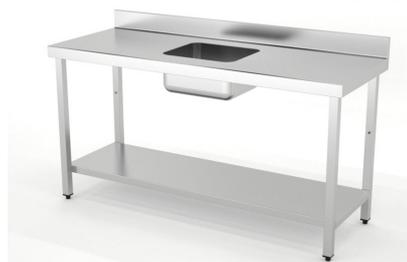
Dimensiones(mm): 1600x700x850. Construidas en Acero Inoxidable AISI 304 18/10 satinado reforzado con omega. Frontal soldado de 60mm en punto redondo. Peto posterior de 100mm con radio sanitario. Cuba soldada 400x340x200mm en mesas fondo 500mm. Cuba soldada 400x400x200mm en mesas fondo 600mm y 700mm. Pata de tubo 40x40 con taco regulable de 60mm. Estante reforzado con omega central.
