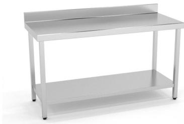
Fondo 700 - Altura 850 Construidas en Acero Inoxidable AISI 304 18/10 satinado y reforzadas con omega. Frontal soldado de 60mm en punto redondo. Patas de tubo 40x40 con taco regulable de 60mm. Estante reforzado con omega central. 6 patas a partir de 2000mm.
