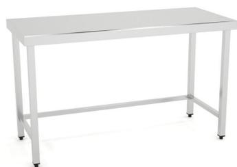
Dimensiones(mm): 600x700x850. Construidas en Acero Inoxidable AISI 304 18/10 satinado reforzado con omega. Frontal soldado de 60mm en punto redondo. Pata de tubo 40x40 con taco regulable de 60mm. Estante reforzado con omega central. 6 patas a partir de 2000mm.
