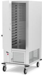
Consumo/tensión: 495w/203v/50hz. Potencia: 1/4cv. Construido en acero inoxidable AISI 304 18/10 satinado, cuba cantos sanitarios para cubetas de 150mm de profundidad. refrigeradas mediante serpentín oculto, aislamiento en poliestireno expandido densidad 30kg/m3,unidad condensadora ubicada parte inferior, termostato digital, 4 ruedas giratorias reforzadas de 125ø (2 con freno).
