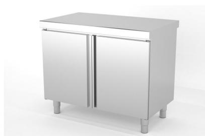
Construidos en Acero Inoxidable AISI 304 18/10 satinado, excepto omegas. Frontal soldado de 60mm en punto redondo. Estante base con doble omega de refuerzo, estante regulable intermedio reforzado con omega central. Puertas a 1 cara con bisagra vertical pivotante. 6 patas y refuerzo central a partir de 2000mm. Pata cilíndrica de acero inoxidable 150mm regulable 50mm. Se suministran totalmente montados...
