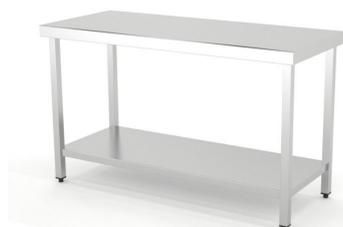
Dimensiones(mm): 600x700x850. Construidas en Acero Inoxidable AISI 304 18/10 satinado reforzado con omega. Frontal soldado de 60mm en punto redondo. Pata de tubo 40x40 con taco regulable de 60mm. Estante reforzado con omega central. 6 patas a partir de 2000mm.
