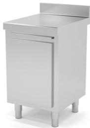
Construidos en Acero Inoxidable AISI 304 18/10 satinado, excepto omegas. Frontal soldado de 60mm en punto redondo. Peto posterior soldado de 100mm con radio sanitario. Estante base con doble omega de refuerzo. Pata cilíndrica de acero inoxidable 150mm regulable 50mm. Se suministran totalmente montados y soldados en embalaje paletizado.
