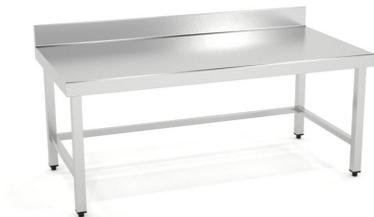
Dimensiones(mm): 600x700x850. Construidas en Acero Inoxidable AISI 304 18/10 satinado y reforzadas con omega. Frontal soldado de 60mm en punto redondo. Peto posterior soldado de 100mm con radio sanitario. Pata de tubo 40x40mm con taco regulable de 60mm. Estante reforzado con omega central. 6 patas a partir de 2000mm.
