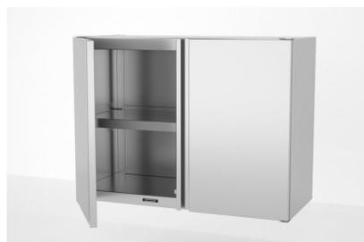
Construidos en Acero Inoxidable AISI 304 18/10. Estante base con doble omega de refuerzo, 1 estante intermedio regulable y reforzado con omega inoxidable. Puerta abatible con bisagra pivotante. Se suministran totalmente montados y soldados en embalaje paletizado.
