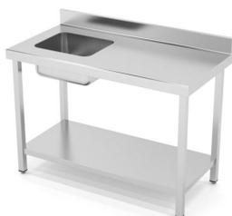
Dimensiones(mm): 1000x700x850. Construidas en Acero Inoxidable AISI 304 18/10 satinado reforzado con omega. Frontal soldado de 60mm en punto redondo. Peto posterior soldado de 100mm con radio sanitario. Cuba soldada 400x340x200mm en mesas fondo 500mm. Cuba soldada 400x400x200mm en mesas fondo 600mm y 700mm. Pata de tubo 40x40 con taco regulable de 60mm. Estante reforzado con omega central.
