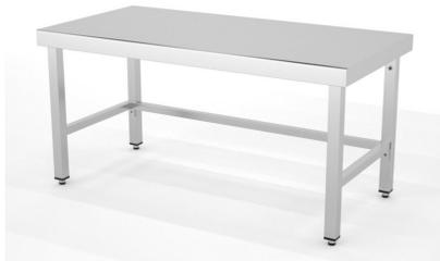
Mesas de fondo 600 y altura 600. Construidas en Acero Inoxidable AISI 304 18/10 satinado y reforzadas con omega. Frontal soldado de 60mm en punto redondo. Pata de tubo 40x40 con taco regulable de 60mm. \* 6 patas a partir de 2000mm.
