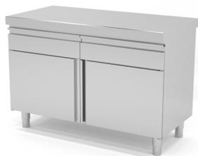
Construidos en Acero Inoxidable AISI 304 18/10 satinado, excepto omegas. Frontal soldado de 60mm en punto redondo. Estante base con doble omega de refuerzo, cajones con guías telescópicas, puertas a 1 cara con bisagra vertical pivotante. Pata cilíndrica de acero inoxidable 150mm regulable 50mm. Se suministran totalmente montados y soldados en embalaje paletizado.
