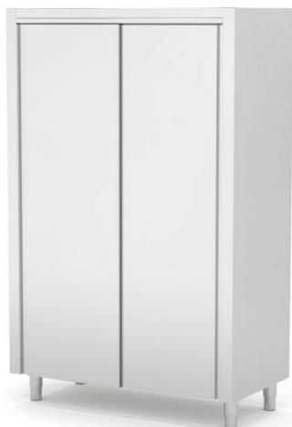
Construidos en Acero Inoxidable AISI 304 18/10. Estante base con doble omega de refuerzo, 3 estantes intermedios regulables y reforzados con omegas inoxidables. Puertas con bisagra vertical desmontable. 6 patas y refuerzo central a partir de 1400mm. Pata cilíndrica de acero inoxidable 150mm regulable 50mm. Se suministran totalmente montados y soldados en embalaje paletizado.
