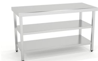
Dimensiones(mm): 600x800x850. Construidas en Acero Inoxidable AISI 304 18/10 satinado y reforzadas con omega. Frontal soldado de 60mm en punto redondo. Patas de tubo 40x40 con taco regulable de 60mm. Estante reforzado con omega central. 6 patas a partir de 2000mm.
