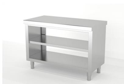
Construidos en Acero Inoxidable AISI 304 18/10 satinado, excepto omegas. Frontal soldado de 60mm en punto redondo. Estante base con doble omega de refuerzo, estante regulable intermedio reforzado con omega central. 6 patas y refuerzo central a partir de 2000mm. Pata cilíndrica de acero inoxidable 150mm regulable 50mm. Se suministran totalmente montados y soldados en embalaje paletizado.
