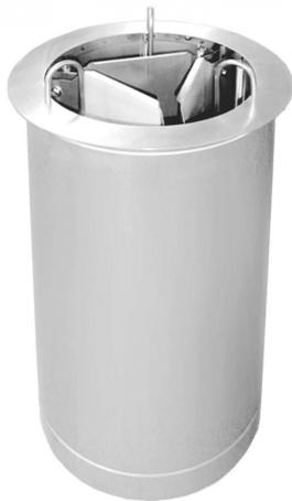
Construidos en Acero Inoxidable AISI 304 18/10 satinado. sistema de muelles para regulación altura de platos, capacidad aproximada para 60 platos por poza, diámetro regulable para platos de 180ø a 260ø y de 240ø a 320ø (según modelo). Modelos calientes calefactados con resistencias, termostato regulación temperatura 0º-90º. Elementos para encastrar en encimera. Se suministran en embalaje paletizado...
