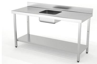
Dimensiones(mm): 1600x700x850. Construidas en Acero Inoxidable AISI 304 18/10 satinado reforzado con omega. Frontal soldado de 60mm en punto redondo. Peto posterior soldado de 100mm con radio sanitario. Cuba soldada 400x340x200mm en mesas fondo 500mm. Cuba soldada 400x400x200mm en mesas fondo 600mm y 700mm. Pata de tubo 40x40 con taco regulable de 60mm. Estante reforzado con omega central.
