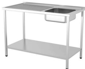
Alto: 850 mm Construidos en Acero Inoxidable AISI 304 18/10 satinado. Frontal 30mm en punto recto. Peto posterior 30mm girada recta. Válvula con tapón incluidos. Pata de tubo 30x30mm con taco regulable hasta 30mm. 1 estante inferior soldado a estructura en modelo con estante. Se suministran totalmente montados y soldados. Gama de fregaderos soldados de alta calidad fabricados en España diseñados con ba...
