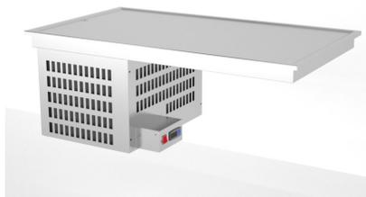
Construidas en Acero Inoxidable AISI 304 18/10. Placa con perfil vierteaguas perimetral. Refrigeradas mediante serpentín oculto. Aisladas con poliestileno expandido. Desagüe inferior en placa. Unidad condensadora incorporada en parte inferior, con cuadro de mandos móvil (máx. 1m). Temperatura de trabajo 0°C / 4°C. Elementos para encastrar en encimera. Se suministran en embalaje paletizado.
