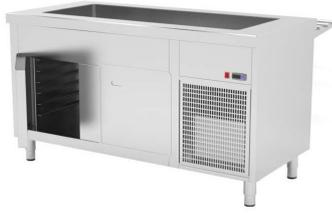
Construidos en Acero Inoxidable AISI 304 18/10 satinado. Frontal soldado de 60mm, Cuba con radios sanitarios para cubetas de 150mm de profundidad. Refrigeradas mediante serpentín oculto. Aisladas con poliestileno expandido. Desagüe inferior en cuba, termostato digital, reserva inferior refrigerada, puertas batientes aisladas con guías para cubetas GN1/1 en zona de reserva, decoración frontal en ac...
