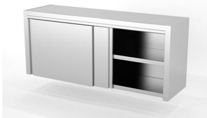
Construidos en Acero Inoxidable AISI 304 18/10. Estante base con doble omega de refuerzo, escurridor de varilla desmontable en modelo con escurridor, 1 estante intermedio regulable y reforzado con omega inoxidable. Puertas correderas con rodamiento superior de nylon. Refuerzo central a partir de 1400mm. Se suministran totalmente montados y soldados en embalaje paletizado.
