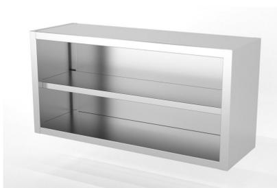
Construido en acero inoxidable AISI 304 18/10 satinado, estante base reforzado con doble omega de refuerzo, 1 estante intermedio regulable y reforzado con omega inoxidable. Se suministran totalmente montados y soldados en embalaje paletizado.
