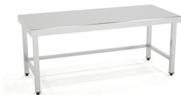
Fondo 600 - Altura 600 Construidas en Acero Inoxidable AISI 304 18/10 satinado y reforzadas con omega. Frontal soldado de 60mm en punto redondo. Patas de tubo 40x40 con taco regulable de 60mm. Estante reforzado con omega central. 6 patas a partir de 2000mm.
