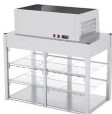
Construidas en Acero Inoxidable AISI 304 18/10 satinado. Iluminación interior LED, Laterales y puertas correderas posteriores de cristal, puertas frontales abatibles de metacrilato transparente. 3 niveles de estante de rejillas inox, Refrigeradas mediante evaporador tiro forzado ubicado en techo. unidad condensadora ubicada en parte superior, Desagüe por gravedad. base inferior con salvaguas tipo...
