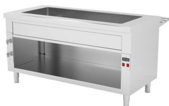
Construidos en Acero Inoxidable AISI 304 18/10 satinado. frontal soldado de 60mm, Cuba con radios sanitarios para cubetas de 150mm de profundidad. Aisladas con lana de roca. Resistencias ocultas. Interruptor ON/OFF luminoso y termostato digital 0°-90°. Llenado y Desagüe con grifo bola. decoración frontal en acero inox con posibilidad de panelado decorativo, pata cilíndrica de acero inoxidable 150m...
