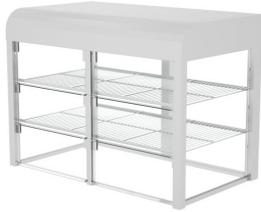
Construidas en Acero Inoxidable AISI 304 18/10 satinado. Laterales y puertas correderas posteriores de cristal, puertas frontales abatibles de metacrilato transparente. Refrigeradas mediante evaporador tiro forzado ubicado en techo. Iluminación interior LED. Aisladas con poliestireno expandido. Temperatura de trabajo 5°C / 10°C. Sin base inferior, se suministran totalmente montadas en caso de comp...
