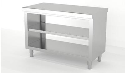
Construidos en Acero Inoxidable AISI 304 18/10 satinado, excepto omegas. Frontal soldado de 60mm en punto redondo. Estante base con doble omega de refuerzo, estante regulable intermedio reforzado con omega central. 6 patas y refuerzo central a partir de 2000mm. Pata cilíndrica de acero inoxidable 150mm regulable 50mm. Se suministran totalmente montados y soldados en embalaje paletizado.
