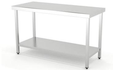
Dimensiones(mm): 600x700x850. Construidas en Acero Inoxidable AISI 304 18/10 satinado y reforzadas con omega. Frontal soldado de 60mm en punto redondo. Patas de tubo 40x40 con taco regulable de 60mm. Estante reforzado con omega central. 6 patas a partir de 2000mm.
