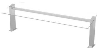
Construidas en Acero Inoxidable AISI 304 18/10. Soportes verticales en tubo rectangular 60x40mm o 100x50mm unidos con tubo horizontal o cuerpo de pantalla (según modelo) cristal superior inclinado con sujeción mediante tornillos. fijación inferior mediante pieza de anclaje a encimera. soportes 60x40mm Cristal no incluido en el precio
