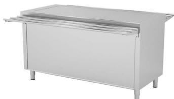
Construidos en Acero Inoxidable AISI 304 18/10 satinado. frontal soldado de 60mm, Cuba con radios sanitarios para cubetas de 150mm de profundidad. Refrigeradas mediante serpentín oculto. Aisladas con poliestileno expandido. Desagüe inferior en cuba. termostato digital, decoración a 2 caras en acero inox con posibilidad de panelado decorativo, pata cilíndrica de acero inoxidable 150mm regulable 50m...
