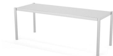
Construidos en Acero Inoxidable AISI 304 18/10 satinado y reforzados con omegas inoxidables. Se suministran totalmente montados, soldados y embalados. 6 patas a partir de 2100mm. Dotación de tornillos para su fijación a encimera.
