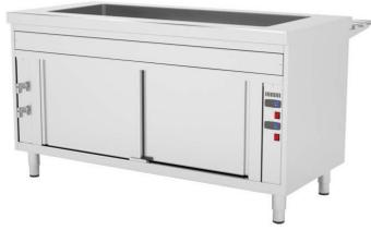
Construidos en Acero Inoxidable AISI 304 18/10 satinado. Frontal soldado de 60mm, Cuba con radios sanitarios para cubetas de 150mm de profundidad. Aisladas con lana de roca. Resistencias ocultas. Doble interruptor ON/OFF luminoso y doble termostato digital 0°-90°. Llenado y Desagüe con grifo bola. Puertas correderas en zona reserva, decoración frontal en acero inox con posibilidad de panelado decor...
