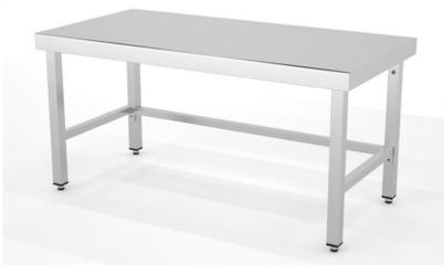
Mesas de fondo 700 y altura 600. Construidas en Acero Inoxidable AISI 304 18/10 satinado y reforzadas con omega. Frontal soldado de 60mm en punto redondo. Pata de tubo 40x40 con taco regulable de 60mm. 6 patas a partir de 2000mm.
