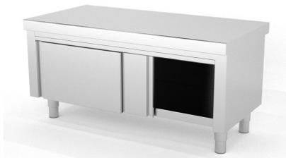
Construidos en Acero Inoxidable AISI 304 18/10 satinado, excepto omegas. Frontal soldado de 60mm en punto redondo. Estante base con doble omega de refuerzo, estante regulable intermedio reforzado con omega central. Puertas correderas a 1 cara con rodamiento superior de nylon. 6 patas y refuerzo central a partir de 2000mm. Pata cilíndrica de acero inoxidable 150mm regulable 50mm. Se suministran total...
