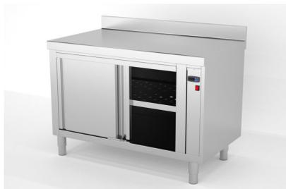
Tensión: 230v/50/60Hz. Construidos en Acero Inoxidable AISI 304 18/10 satinado y reforzados, excepto omegas. Frontal soldado de 60mm en punto redondo. Peto posterior soldado de 100mm con radio sanitario. Aislados con lana de roca. Bloque calórico lateral con resistencias ventiladas. Interruptor ON/OFF luminosos y termostato digital 0°-90°. Pata cilíndrica de acero inoxidable 150mm regulable 50mm. Puertas...
