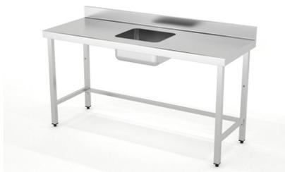
Dimensiones(mm): 1600x700x850. Construidas en Acero Inoxidable AISI 304 18/10 satinado reforzado con omega. Frontal soldado de 60mm en punto redondo. Peto posterior de 100mm con radio sanitario. Cuba soldada 400x340x200mm en mesas fondo 500mm. Cuba soldada 400x400x200mm en mesas fondo 600mm y 700mm. Pata de tubo 40x40 con taca regulable de 60mm. Estante reforzado con omega central.
