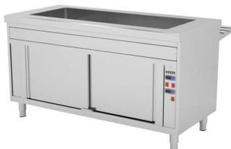
Construidos en Acero Inoxidable AISI 304 18/10 satinado. Frontal soldado de 60mm, Cuba con radios sanitarios para cubetas de 150mm de profundidad. Aisladas con lana de roca. Resistencias vistas con chapa perforada de protección. Doble interruptor ON/OFF luminoso y doble termostato digital 0°-90°. Puertas correderas en zona reserva, decoración frontal en acero inox con posibilidad de panelado decora...
