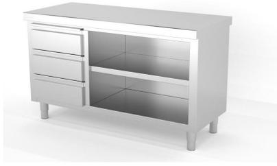
Construidos en Acero Inoxidable AISI 304 18/10 satinado, excepto omegas. Frontal soldado de 60mm en punto redondo. Estante base con doble omega de refuerzo, estante regulable intermedio. Cajones con guías telescópicas. Pata cilíndrica de acero inoxidable 150mm regulable 50mm. 6 patas a partir de 2000mm. Se suministran totalmente montados y soldados en embalaje paletizado.
