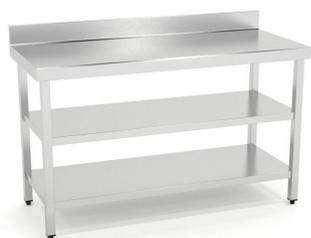
Construidas en Acero Inoxidable AISI 304 18/10 satinado. Frontal de 40mm en mesas de 700mm. Peto trasero girada recta de 40mm en mesas de 700mm. Pata de tubo 30x30 con taco regulable hasta 30mm. Se suministran totalmente soldadas
