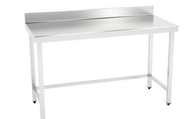
Dimensiones(mm): 600x600x850. Construidas en Acero Inoxidable AISI 304 18/10 satinado y reforzadas con omega. Frontal soldado de 60mm en punto redondo. Patas de tubo 40x40 con taco regulable de 60mm. Estante reforzado con omega central. 6 patas a partir de 2000mm.
