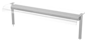
Construidas en Acero Inoxidable AISI 304 18/10. Soportes verticales en tubo redondo 50°, unidos con tubo horizontal o cuerpo de pantalla (según modelo) Anclajes superiores para sujeción de cristal. Fijación inferior mediante varilla roscada a encimera. Se suministran en embalaje paletizado.
