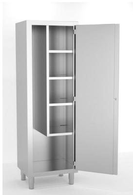
Construidos en Acero Inoxidable AISI 304 18/10. Estante base con doble omega de refuerzo, 4 estantes intermedios soldados y reforzados con omegas inoxidables. Puertas con bisagra vertical. Cerradura con llave incluida. Pata cilíndrica acero inoxidable regulable 50mm. Se suministran totalmente montados y soldados en embalaje paletizado.
