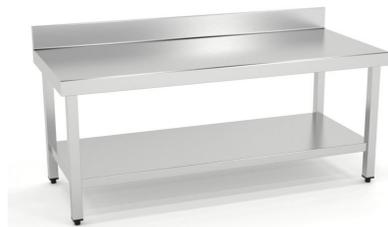
Construidas en Acero Inoxidable AISI 304 18/10 satinado. Frontal de 40mm en mesas de 700. Peto trasero girada recta de 40mm en mesas de 700. Pata de tubo 30x30 con taco regulable hasta 30mm.
