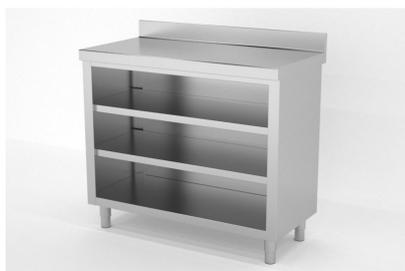
Construidos en Acero Inoxidable AISI 304 18/10 satinado, excepto omegas. Frontal soldado de 60mm en punto redondo. Peto posterior de 100mm con radio sanitario. Estante base con doble omega de refuerzo, estantes intermedios regulables reforzados con omega central. Pata cilíndrica de acero inoxidable 150mm regulable 50mm. Se suministran totalmente montados y soldados en embalaje paletizado.
