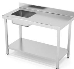
Dimensiones(mm): 1000x600x850. Construidas en Acero Inoxidable AISI 304 18/10 satinado reforzado con omega. Frontal soldado de 60mm en punto redondo. Peto posterior soldado de 100mm con radio sanitario. Cuba soldada 400x340x200mm en mesas fondo 500mm. Cuba soldada 400x400x200mm en mesas fondo 600mm y 700mm. Pata de tubo 40x40 con taco regulable de 60mm. Estante reforzado con omega central.
