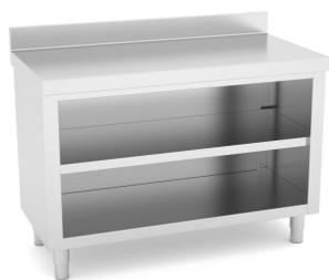
Construidos en Acero Inoxidable AISI 304 18/10 satinado, excepto omegas. Frontal soldado de 60mm en punto redondo. Peto posterior soldado de 100mm con radio sanitario. Estante base con doble omega de refuerzo, estante regulable intermedio reforzado con omega central. 6 patas y refuerzo central a partir de 2000mm. Pata cilíndrica de acero inoxidable 150mm regulable 50mm. Se suministran totalmente mon...
