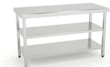
Dimensiones(mm): 600x600x850. Construidas en Acero Inoxidable AISI 304 18/10 satinado y reforzadas con omega. Frontal soldado de 60mm en punto redondo. Patas de tubo 40x40 con taco regulable de 60mm. Estante reforzado con omega central. 6 patas a partir de 2000mm.
