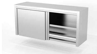
Construidos en Acero Inoxidable AISI 304 18/10. Estante base con doble omega de refuerzo, escurridor de varilla desmontable en modelo con escurridor, 1 estante intermedio regulable y reforzado con omega inoxidable. Puertas correderas con rodamiento superior de nylon. Refuerzo central a partir de 1400mm. Se suministran totalmente montados y soldados en embalaje paletizado.
