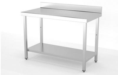
Dimensiones(mm): 600x500x850. Construidas en Acero Inoxidable AISI 304 18/10 satinado y reforzadas con omega. Frontal soldado de 60mm en punto redondo. Patas de tubo 40x40 con taco regulable de 60mm. Estante reforzado con omega central. 6 patas a partir de 2000mm.
