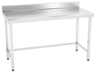
Dimensiones(mm): 600x700x850. Construidas en Acero Inoxidable AISI 304 18/10 satinado y reforzadas con omega. Frontal soldado de 60mm en punto redondo. Patas de tubo 40x40 con taco regulable de 60mm. Estante reforzado con omega central. 6 patas a partir de 2000mm.
