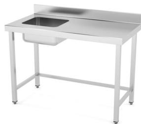
Dimensiones(mm): 1200x500x850. Construidas en Acero Inoxidable AISI 304 18/10 satinado reforzado con omega. Frontal soldado de 60mm en punto redondo. Peto posterior soldado de 100mm con radio sanitario. Cuba soldada 400x340x200mm en mesas fondo 500mm. Cuba soldada 400x400x200mm en mesas fondo 600mm y 700mm. Pata de tubo 40x40 con taco regulable de 60mm. Estante reforzado con omega central.
