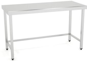
Dimensiones(mm): 600x700x850. Construidas en Acero Inoxidable AISI 304 18/10 satinado y reforzadas con omega. Frontal soldado de 60mm en punto redondo. Patas de tubo 40x40 con taco regulable de 60mm. Estante reforzado con omega central. 6 patas a partir de 2000mm.
