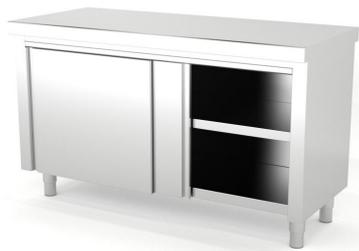
Construidos en Acero Inoxidable AISI 304 18/10 satinado, excepto omegas. Frontal soldado de 60mm en punto redondo. Estante base con doble omega de refuerzo, estante regulable intermedio reforzado con omega central. Puertas correderas a 1 cara con rodamiento superior de nylon. 6 patas y refuerzo central a partir de 2000mm. Pata cilíndrica de acero inoxidable 150mm regulable 50mm. Se suministran totalm...
