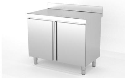
Construidos en Acero Inoxidable AISI 304 18/10 satinado, excepto omegas. Frontal soldado de 60mm en punto redondo. Peto posterior soldado de 100mm con radio sanitario. Estante base con doble omega de refuerzo, estante intermedio reforzado con omega central. Puertas a 1 cara con bisagra vertical pivotante. 6 patas y refuerzo central a partir de 2000mm. Pata cilíndrica de acero inoxidable 150mm regul...
