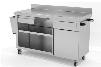
Construidos en Acero Inoxidable AISI 304 18/10 satinado, excepto omegas. Frontal soldado de 60mm en punto redondo. Peto posterior de 100mm visto a 2 caras. Estante base con doble omega de refuerzo, estante intermedio regulable reforzado con omega central, 4 ruedas diámetro 125mm, 2 con freno, 4 parachoques de protección, 1 cajón guías telescópicas, espacio para basura con puerta frontal pivotante ...
