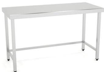
Construidas en Acero Inoxidable AISI 304 18/10 satinado. Frontal de 40mm en mesas de 600. Pata de tubo 30x30 con taco regulable hasta 30mm. Se suministran totalmente montados y soldados.
