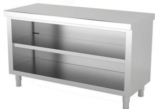
Construidos en Acero Inoxidable AISI 304 18/10 satinado, excepto omegas. Frontal soldado de 60mm en punto redondo. Estante base con doble omega de refuerzo, estante regulable intermedio reforzado con omega central. 6 patas y refuerzo central a partir de 2000mm. Pata cilíndrica de acero inoxidable 150mm regulable 50mm. Se suministran totalmente montados y soldados en embalaje paletizado.
