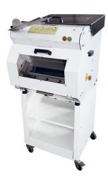
¡La cortadora de autoservicio que permite al cliente seleccionar el pan y cortarlo de forma fácil y segura!La cortadora de pan de autoservicio SS4B está destinada a puntos de ventas y supermercados. No es necesario personal cualificado en la zona de corte ya que puede ser utilizada por los propios clientes. Dispone de carga del pan frontal con apertura y cierre manual de la puerta de carga. El sis...
