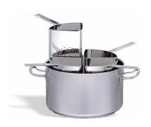
Cazuela cuece pastas, diseñada para ofrecer el mayor rendimiento en la cocina profesional. Cuerpo en acero inoxidable 18/10Asas soldadas Compatible con inducción, gas, vitro y eléctrica Cacerola sin tapa Pulido satinado interior y exterior Radios interiores diseñados para una limpieza fácil y rápida 4 cestas incluídas 35 cm de diámetro 21 cm de altura 20,2 Litros
